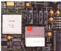
Particolare del 80286/10. Anche intorno ad esso il largo impiego di integrati di montaggio espansi «in».
